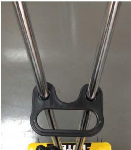
4. Установите верхние рукоятки (2б), прикрепив их с помощью комплекта болтов (7г).
