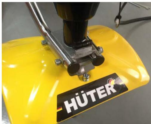
3. Установите транспортировочную ручку (5), надев её сверху нижних частей рукояток (2б)
