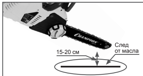
Рис.9 Проверка подачи масла
