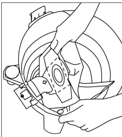
Рис. 6 Установка мешка для сбора пыли
