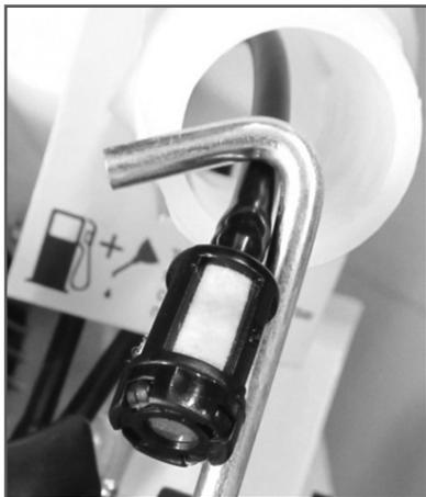
Рис.13 Обслуживание топливного фильтра
