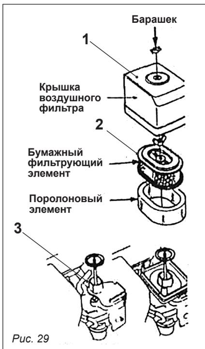
Демонтировать крышку (рис. 29, поз. 1). При отделении крышки от корпуса (рис. 29, поз. 3) не повредить уплотнение.
