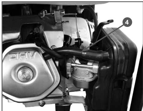
Рис. 13 Трубка системы вентиляции картера
