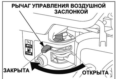
Рис. 11 Воздушная заслонка закрыта
