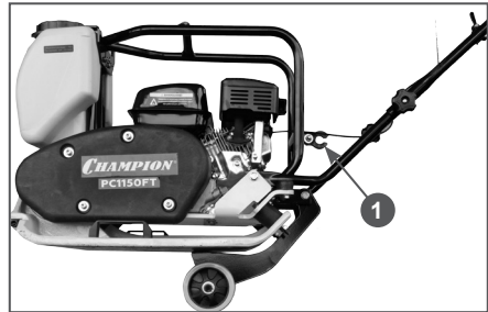
Рис. 27 Использование транспортировочной тележки 1. Зажим
