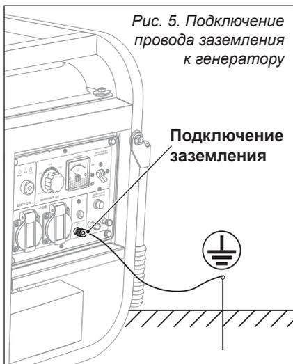
Рис. 5. Подключение провода заземления к генератору
